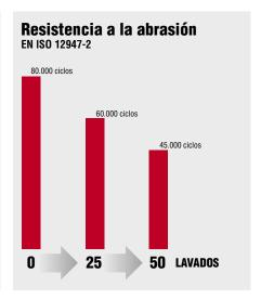
Las pruebas realizadas han confirmado una buena resistencia del tejido a todas las características mecánicas (tracción, laceración, abrasión) tanto horizontal (trama) como vertical (urdimbre). Como se muestra en los gráficos, a pesar de los numerosos lavados, los resultados permanecen muy por encima de los requisitos mínimos requeridos por las principales normas internacionales.
